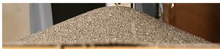
FIG. 4.11 – Photographie d'un tas conique construit par avalanches successives depuis une source ponctuelle située à quelques centimètres du sommet du cône, permettant de mesurer l'angle de repos du matériau : \theta_r = 23^\circ .
