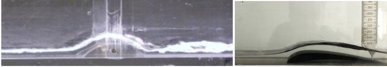
FIGURE 37 – Ecoulement supercritique F > 1 , la surface libre est déviée vers le haut et le fluide est ralenti. Cuve de l'ENSTA Palaiseau à gauche, cuve Sorbonne-U à droite, photos PYL
