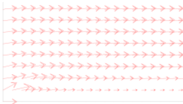
FIG. 8 – résultat rendu par Castem lorsque les deux conditions aux limites sur la vitesse entrent en conflit
