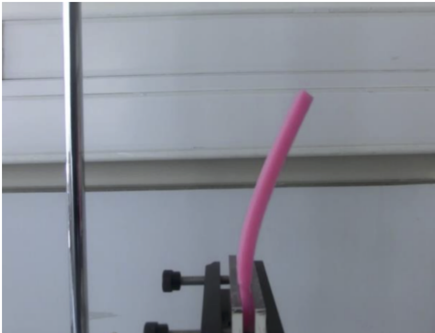
FIGURE 9 – Vibration libre d'une poutre rose
