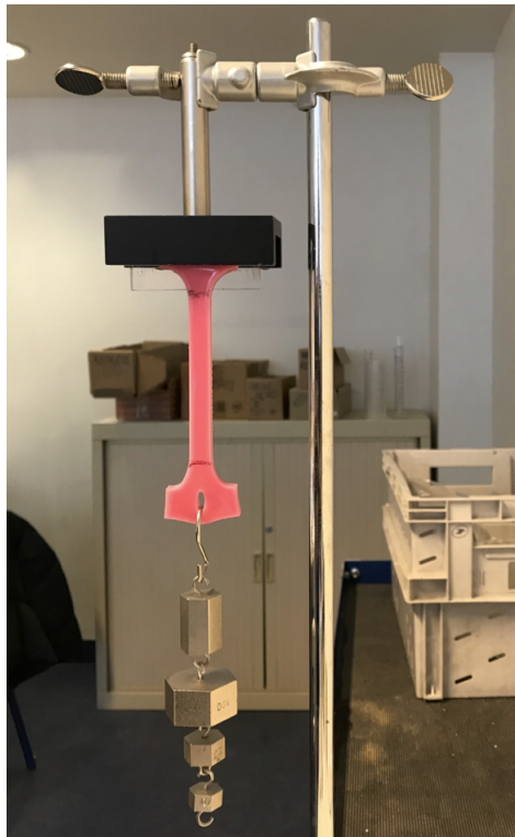
FIGURE 3 – Essai de traction uniaxiale de l'éprouvette rose fine
