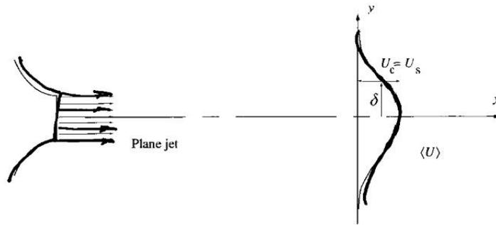
Le jet est dirigé le long de la coordonnée longitudinale  $x$ , se développe selon la direction transverse  $y$ , et peut être considéré statistiquement indépendant de la direction  $z$ . **Le problème peut donc être considéré 2-D.** La largeur caractéristique du jet est appelé  $\delta$ , la longueur caractéristique longitudinale est  $L$ .
