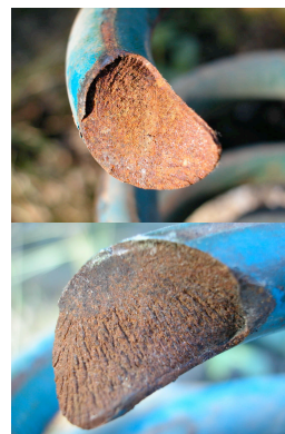
Faciès de rupture d'un amortisseur de Land Rover
