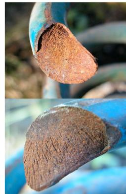
Faciès de rupture d'un amortisseur de Land Rover
