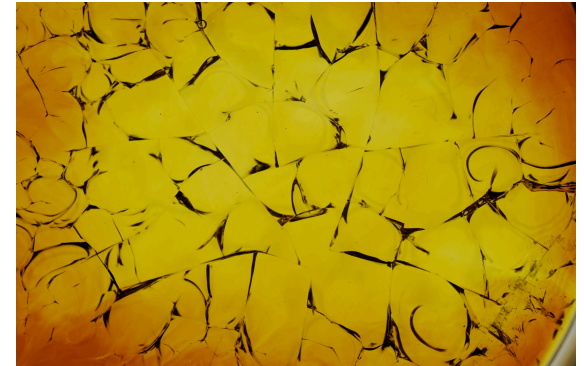
Réseau de fissures obtenu lors du séchage du caramel
