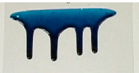
Instabilité "du peintre", similaire à Rayleigh-Taylor, mais avec une ligne de contact
