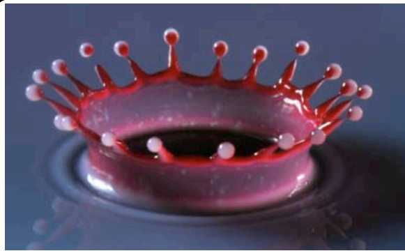
Couronne de Worthington: déstabilisation du bourrelet en gouttelettes lors de l'impact d'une goutte avec un bain liquide.
