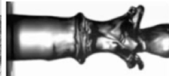
Atomisation: instabilité de la couche de mélange entre un gaz et un liquide, qui donne naissance à des gouttelettes. Le mécanisme est celui de l'instabilité de Kelvin-Helmholtz .
