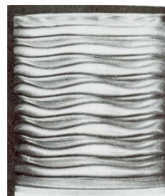
Instabilité de Taylor-Couette entre deux cylindre tournants.
