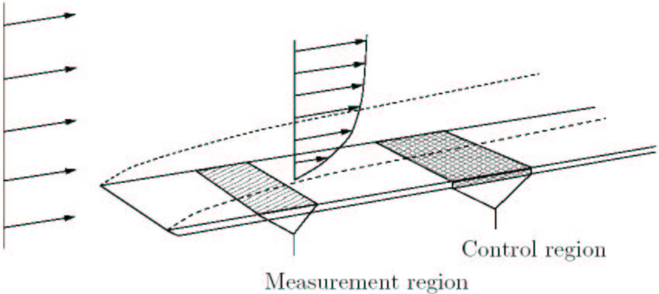
Mesure la **friction** et la **pression** à la paroi
