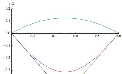
La solution analytique à flux constant en rouge, encadrée par les deux droites de pente -1 et 1, en vert, au dessus, le profil de vitesse.
