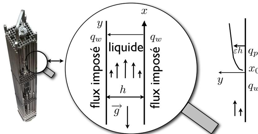
Gauche : la configuration du problème : un assemblage de crayons de 4 m de haut (document Areva), la partie sous la loupe est l'écoulement établi. Centre : "zoom avant" de la question 1, écoulement stationnaire établi en  $x$  (positif vers le haut). Droite : la configuration de la question 3, la couche précédente est soumise à un nouveau flux thermique différent au delà d'une position  $x_0$ . Une couche limite thermique se développe près de la paroi.
