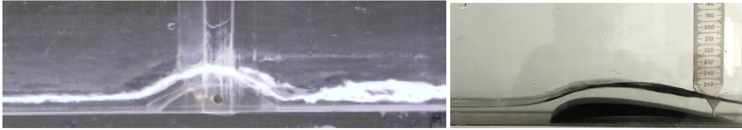
FIGURE 48 – Écoulement supercritique F > 1 , la surface libre est déviée vers le haut et le fluide est ralenti. Cuve de l'ENSTA Palaiseau à gauche, cuve Sorbonne-U à droite, photos PYL
