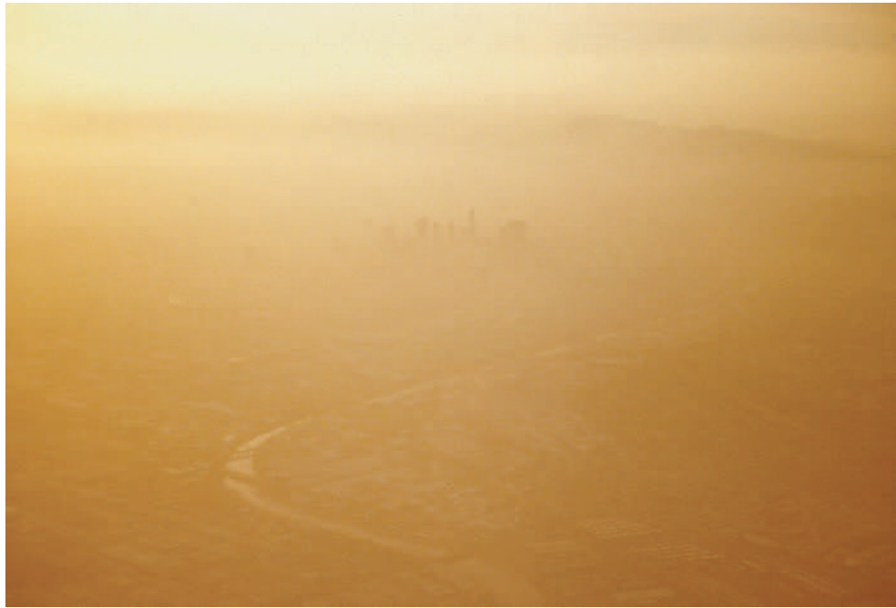
FIGURE 1.2: Exemple d'une stratification stable de densité au-dessus de Los Angeles, créée par la présence de polluant dans les hautes couches de l'atmosphère : celles-ci s'échauffent en absorbant le rayonnement solaire et leur température devient plus élevée que celle du sol. La densité de l'air est alors plus faible qu'au sol, dans cette configuration stable, la pollution ne peut se mélanger avec les autres couches de l'atmosphère ce qui conduit à la formation du "smog".
